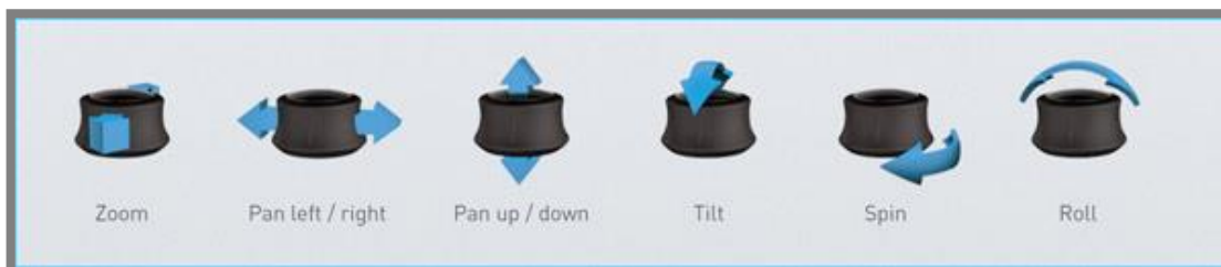
Obr. 2-20 Znázornění možných pohybů 3D controlleru [38]
