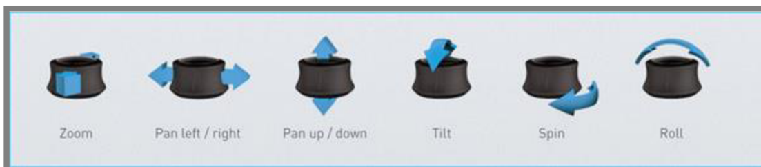
Obr. 2-20 Znázornění možných pohybů 3D controlleru [38]
