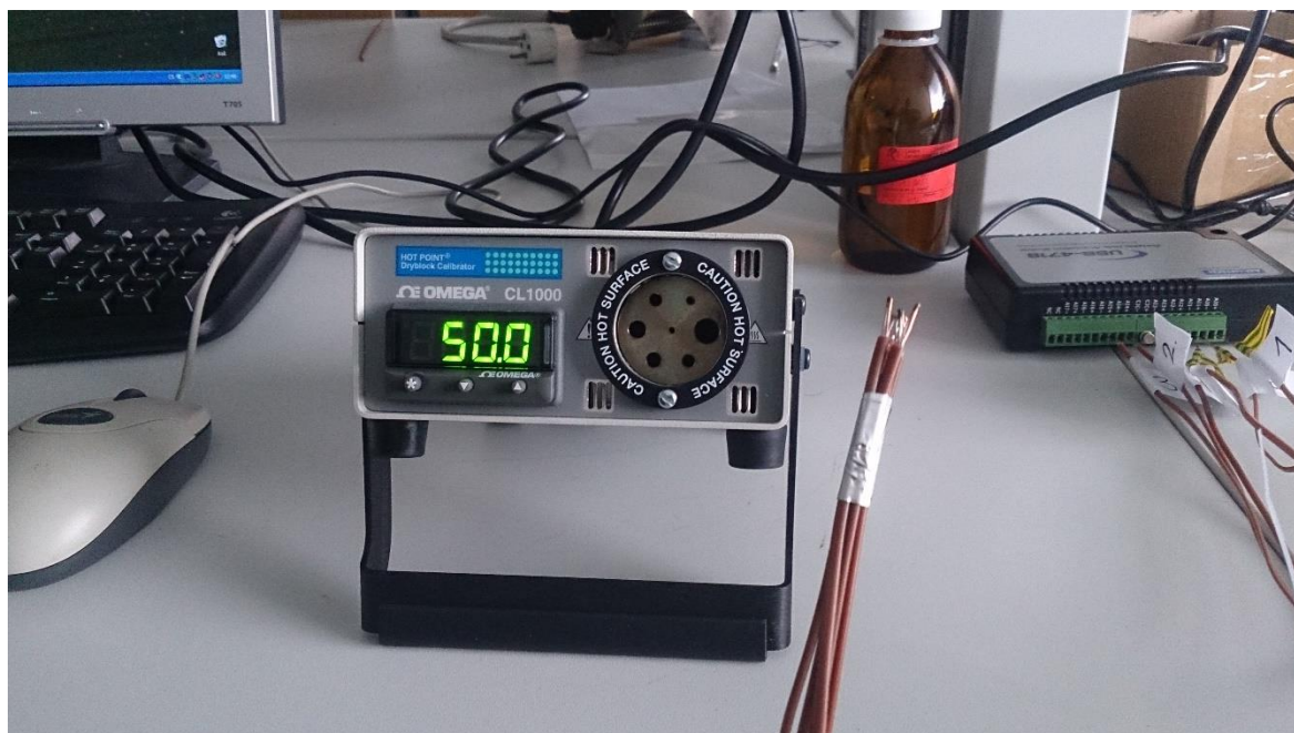
Obrázok 22: Kalibračná piecka so zväzkom termočlánkových drôtov
