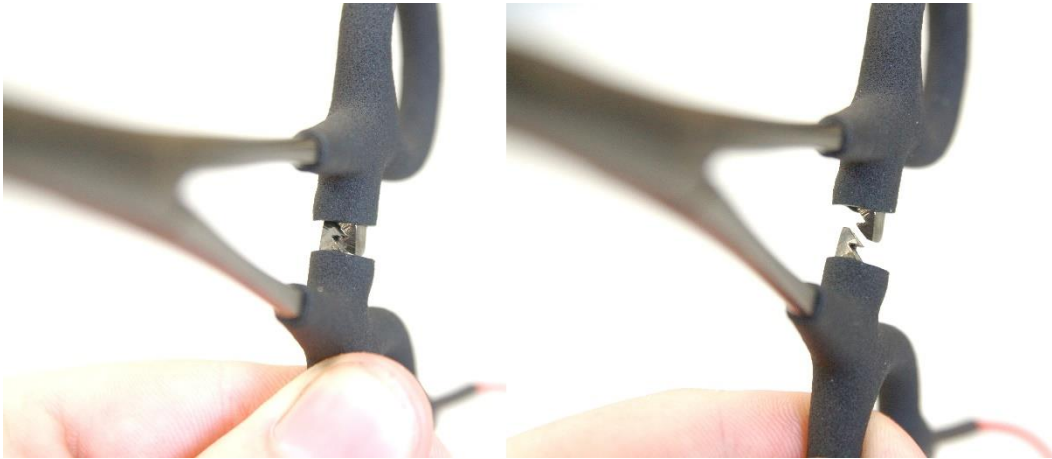
Obrázok 15: Detail zubu na peáne (anóde) po zacviknutí a pred zacviknutím
