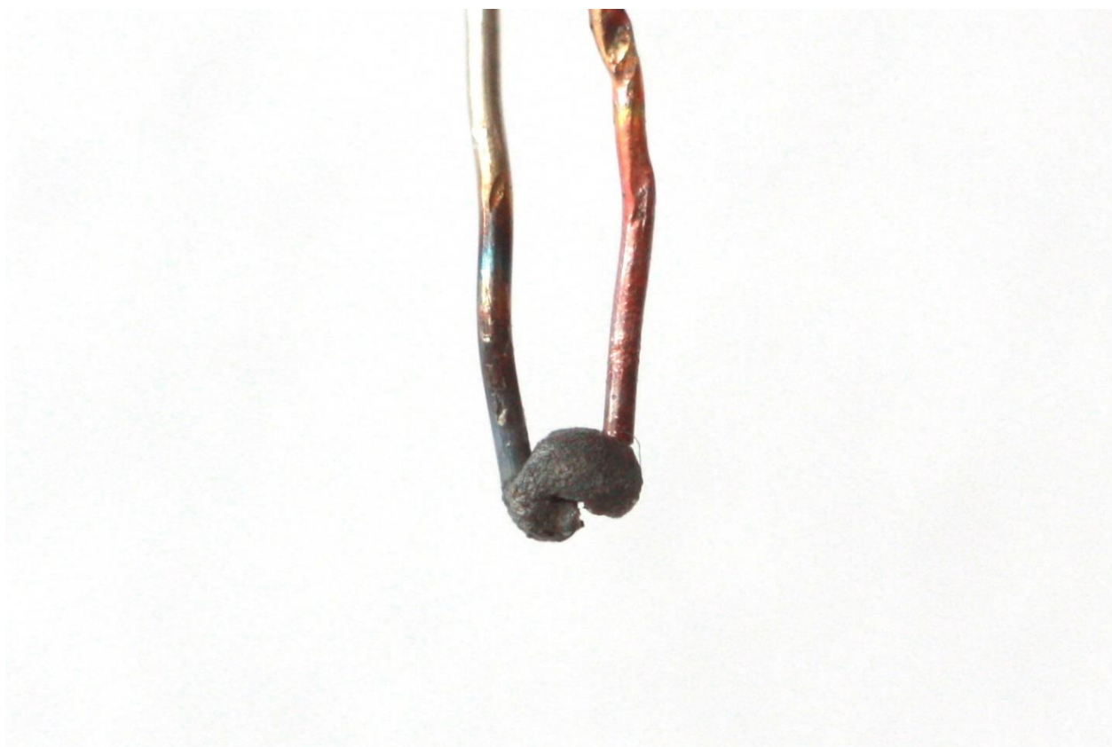
Obrázok zvareného termočlánku s vysokým výbojom
