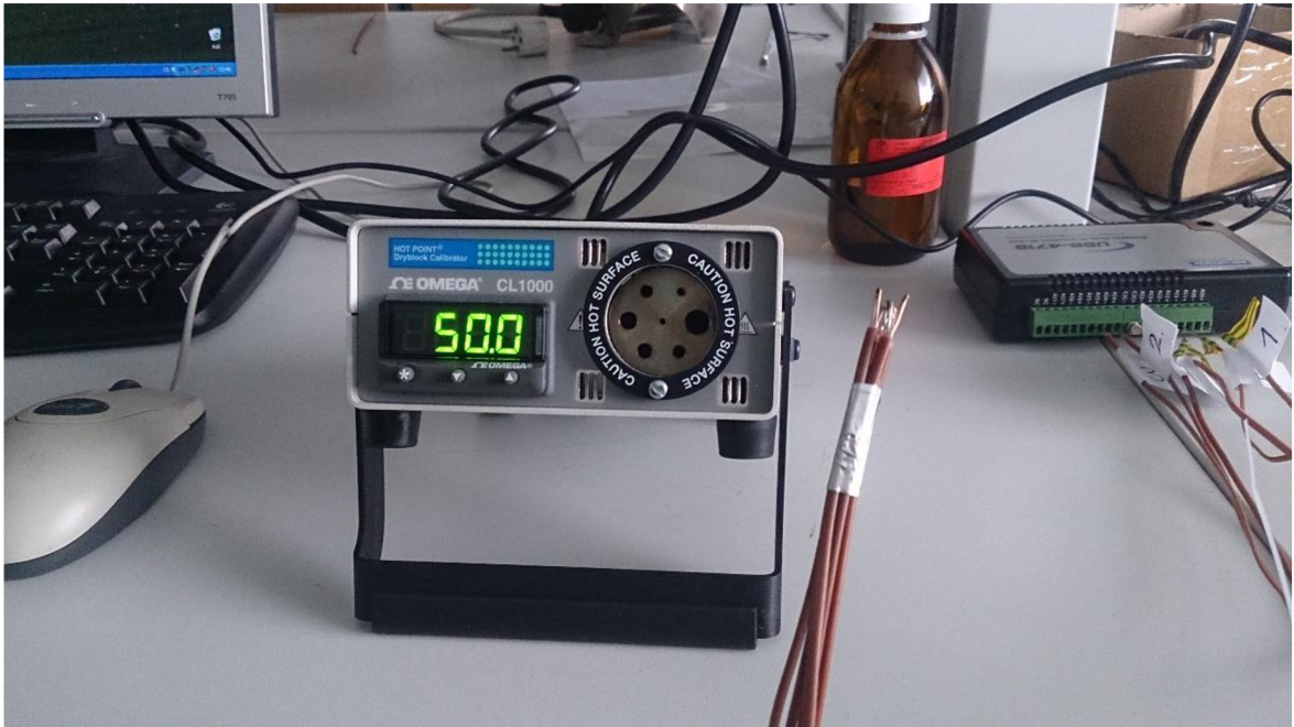
Obrázok 22: Kalibračná piecka so zväzkom termočlánkových drôtov
