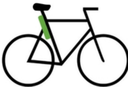
Obrázek 12 - Baterie umístěná za sedlovou trubkou [33]
