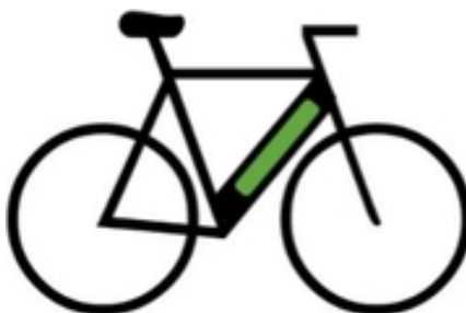
Obrázek 9 - Integrované uložení baterie [33]
