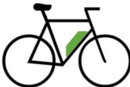
Obrázek 10 - Baterie uložená na spodní rámové trubce [33]
