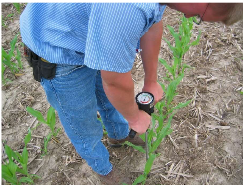
Obrázek 21 Měření penetračního odporu (Jeschke, 2018)
