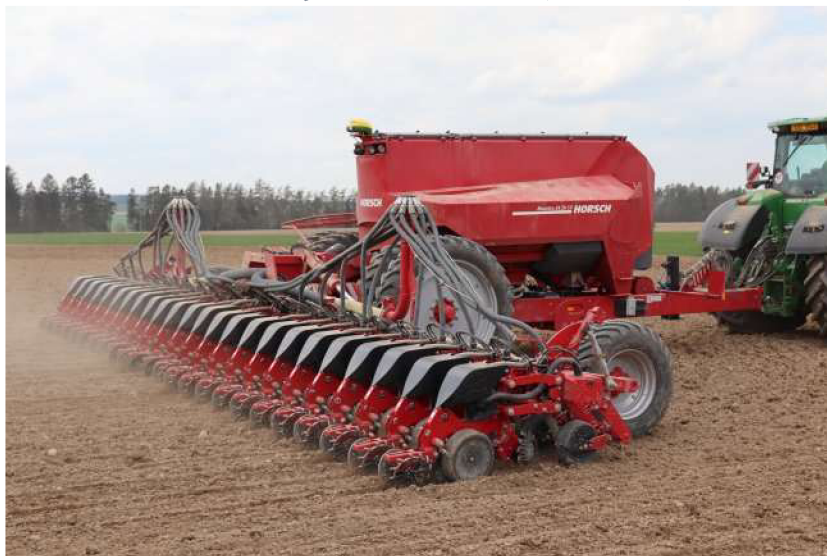
Obrázek 12 Secí stroj Horsch Maestro 12.40 (Jedlička, 2023)
