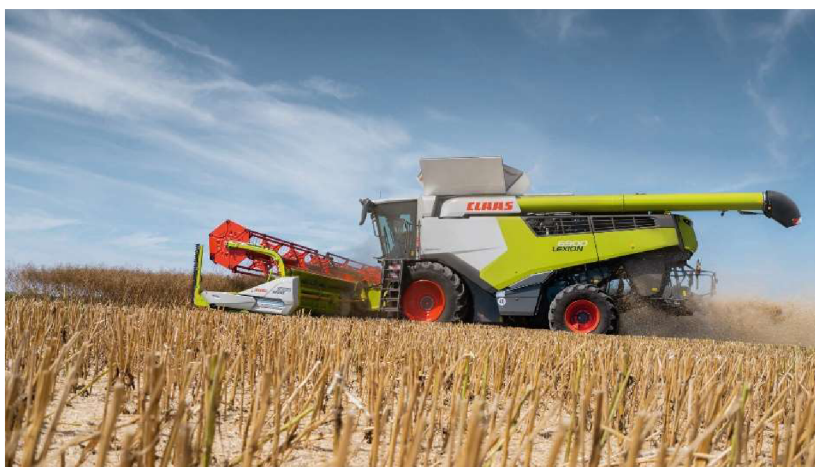
Obrázek 10 Sklízecí mlátička s řepkovým adaptérem (Claas, 2020)
