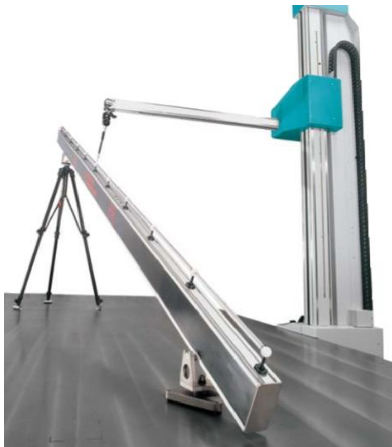
Obr. 21) Kontrolní těleso „Kugelstab 5000 mm fy. KOBA“ na 3D souřadnicovém dotykovém měřicím stroji [11]
