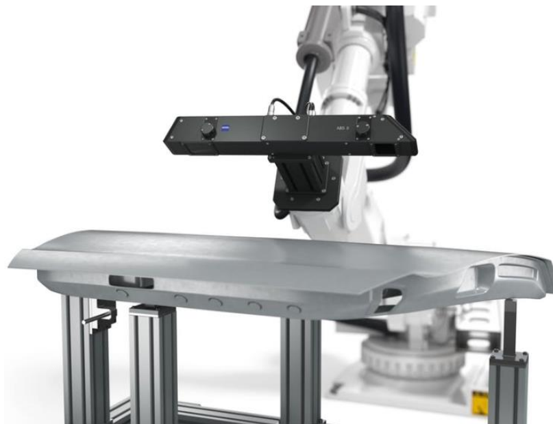
Obr. 49) Skenování strukturovaným světlem firmy ZEISS ABIS II [15]
