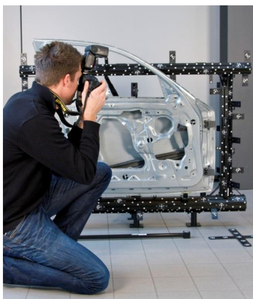
Obr. 7) Fotogrammetrie použitá při kontrole dveří [16]
