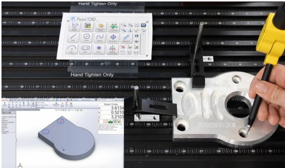
Obr. 8) Kontaktní skenování součásti [18]
