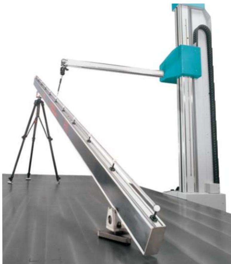
Obr. 21) Kontrolní těleso „Kugelstab 5000 mm fy. KOBA“ na 3D souřadnicovém dotykovém měřícím stroji [11]
