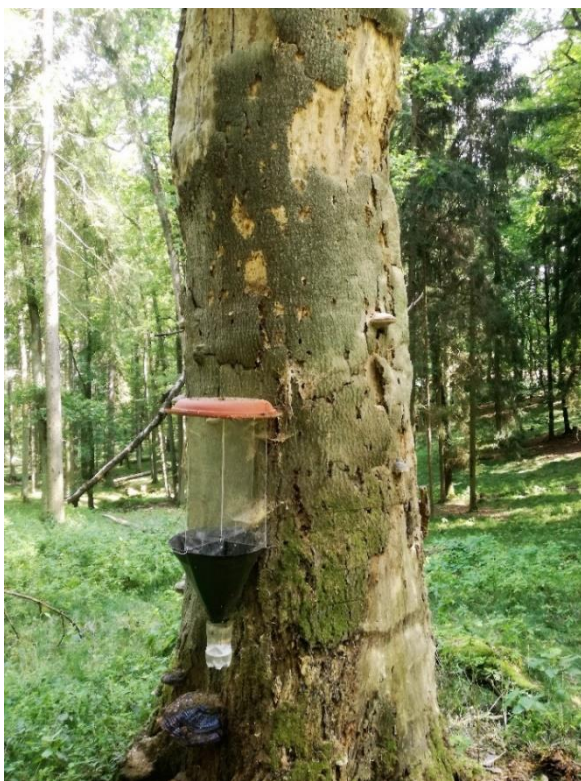
Obrázek 10. Pasivní nárazová kmenová past č. 1.
