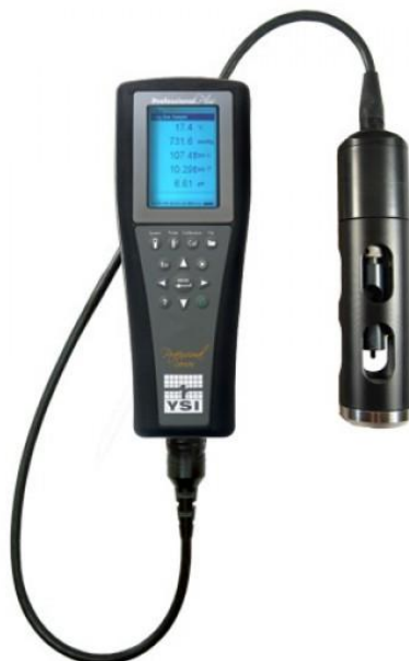
Obr. č. 5. Terénní sonda YSI Professional Plus, která byla použita v průběhu pokusu
