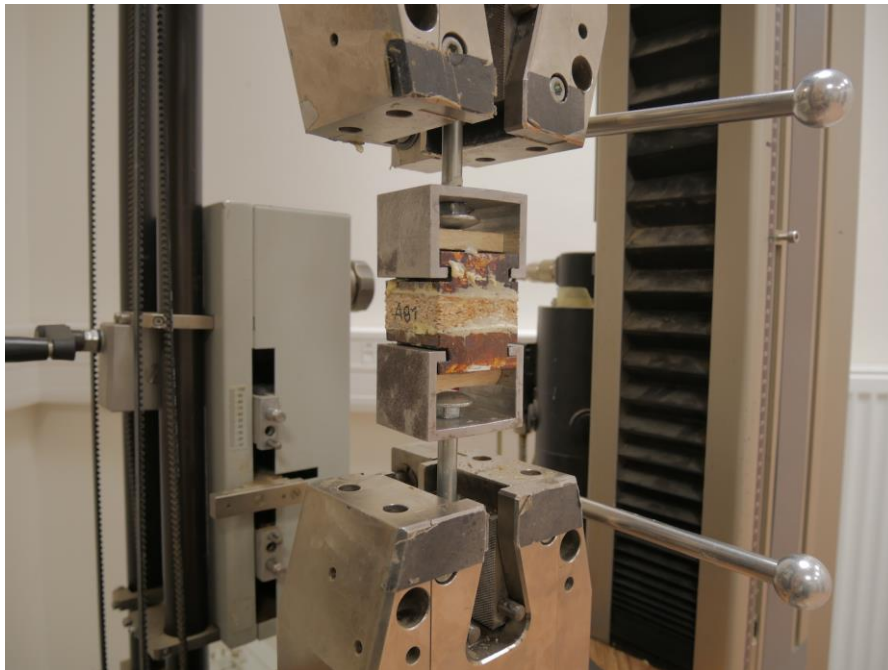
Obr. 14 Probíhající zkouška v tahu na přístroji ZWICK 050 Zdroj: Vlastní pořizovaný snímek z měření
