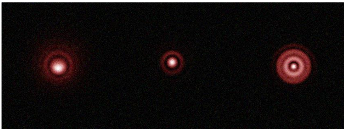
Obr. č. 35: Měření v laboratoři-objektiv 127 - obraz před/v/za ohniskem
