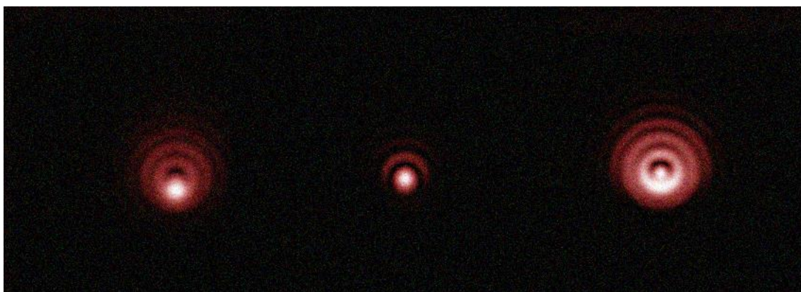
Obr. č. 37: Měření v laboratoři - objektiv 150 - obraz před/v/za objektivem
