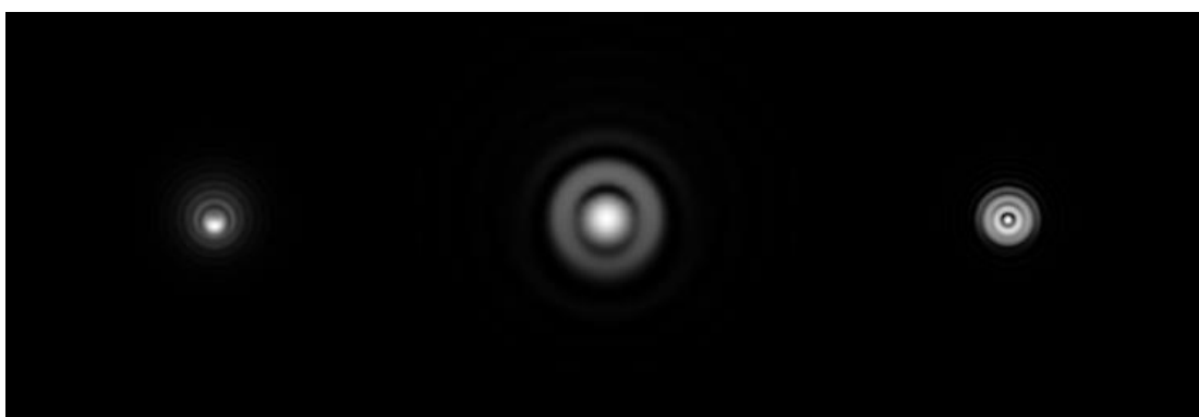
Obr. č. 36: Simulace v programu Aberrator-objektiv 127- obraz před/v/za ohniskem [10]
