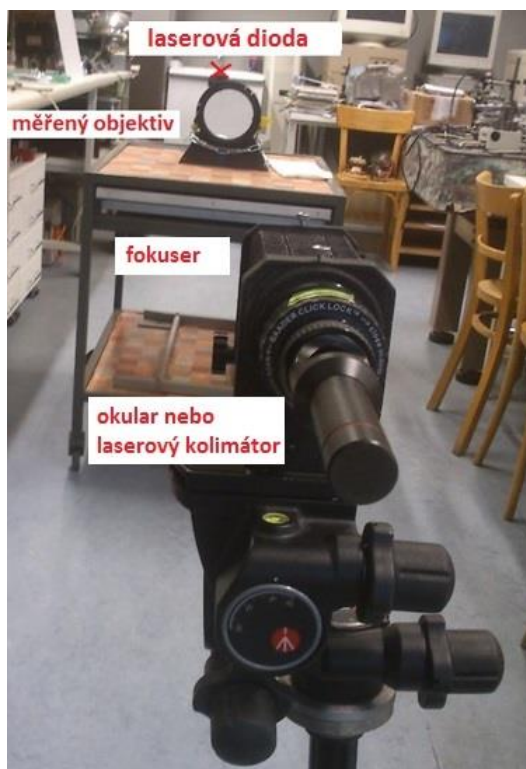
Obr. č. 32: Uspořádání komponentů pro test na hvězdu
