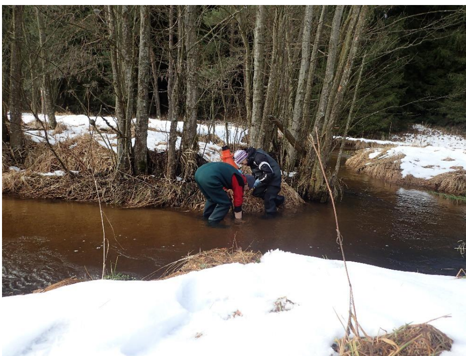
Příloha 51 Ukázka terénních prací přímo při umístování sady teploměrů do toku na lokalitě Dolní Příbrání (DOLP2), 31.1.2018 (na snímku Veronika Stupková a autor práce, autor fotografie Václava Jahelková)
