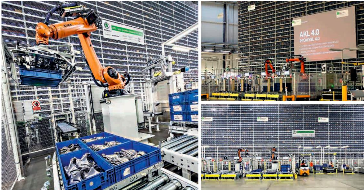
Obrázek 1: Automatický sklad menších dílů
