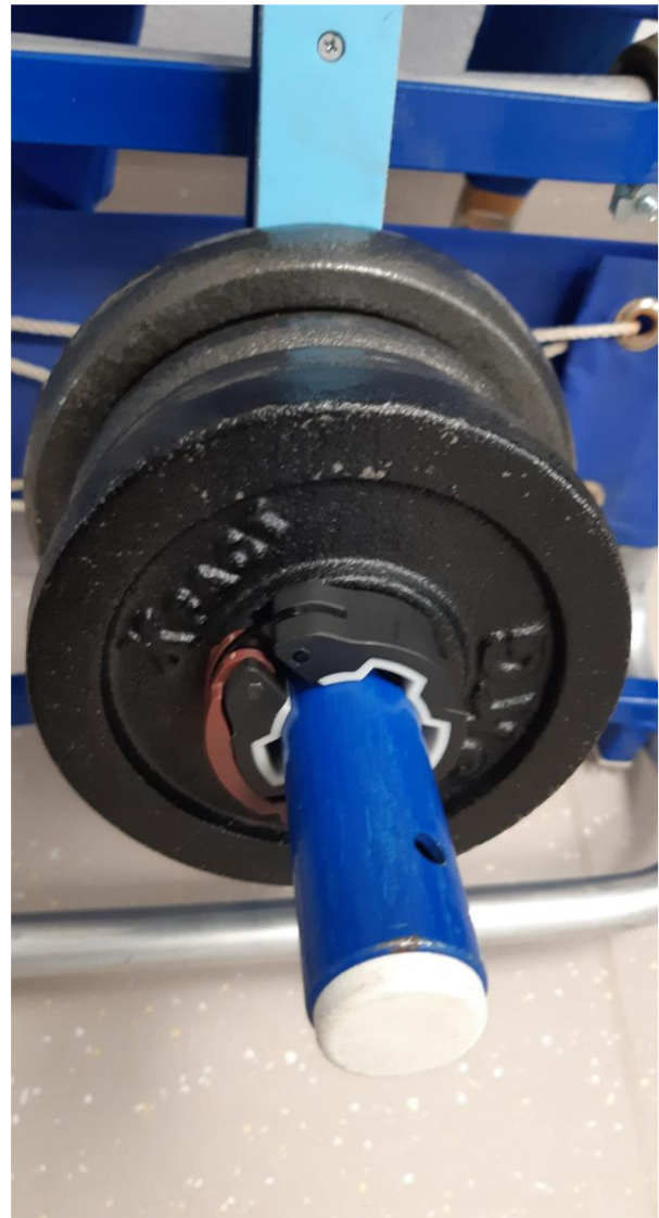
Obrázek 10. Svorka omezující pohyb kotoučů (Archiv autora 2022).
