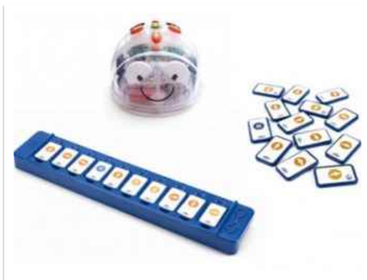
Obr.2: Blue-bot, čtečka, dílky k zadávání algoritmu; Zdroj: https://www.robot-advance.com/EN/art-bundle-bluebot-robot-and-programming-bar-1816.htm
