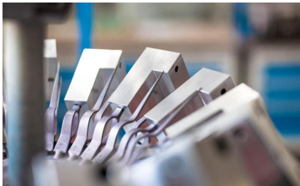
Obrázek 18: Součásti v přípravku před eloxováním [7]
