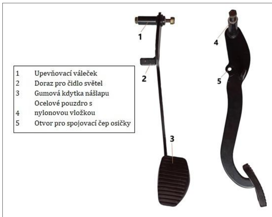
Obrázek 4: Brzdový pedál užitékového vozu s popisky
