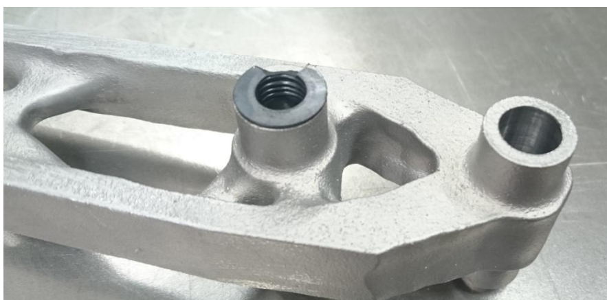
Obrázek 29: Deformace ložisek po zkoušce
