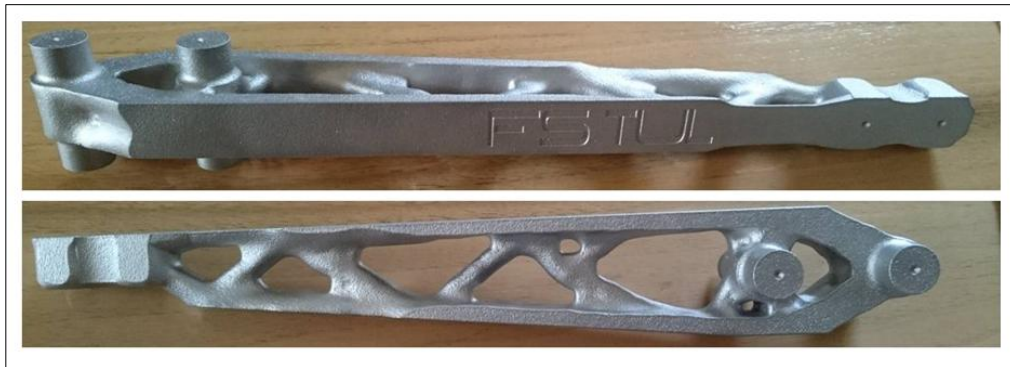
Obrázek 24: Brzdový pedál po dokončení tisku
