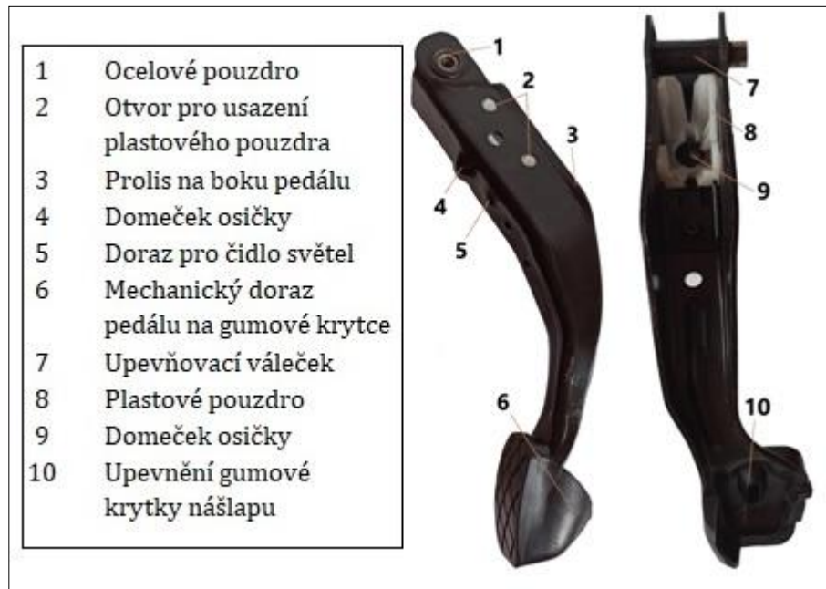
Obrázek 2: Brzdový pedál soudobého vozidla s popisky
