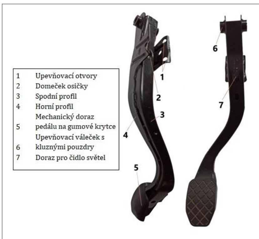
Obrázek 3: Brzdový pedál vozidla vyšší třídy s popisem
