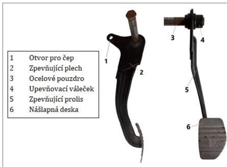
Obrázek 1: Brzdový pedál automobilu staršího data výroby s popisky
