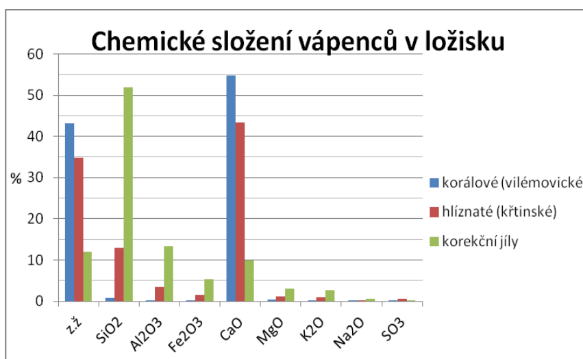
Obr. 1 Chemické složení vápenců v ložisku (Chrha, 1977)
