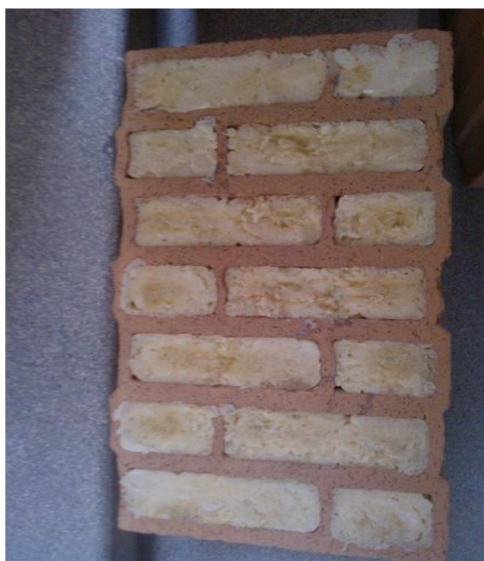
Obrázek č. 14 – Celoroční pěna aplikovaná do keramické tvarovky (vzorek č. 1)
