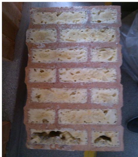
Obrázek č. 15 – Nízko expanzní pěna aplikovaná do keramické tvarovky (vzorek č. 2)
