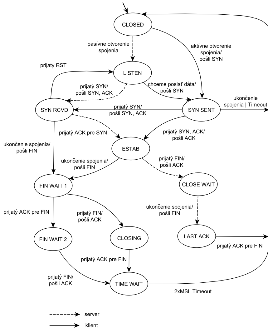
Obrázok 2.5: Stavový diagram TCP.
