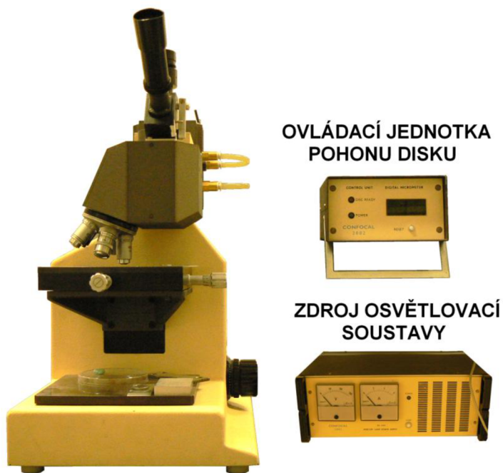
Obrázek 8: Sestava konfokálního mikroskopu Confocal 2002. Převzato z [4].
