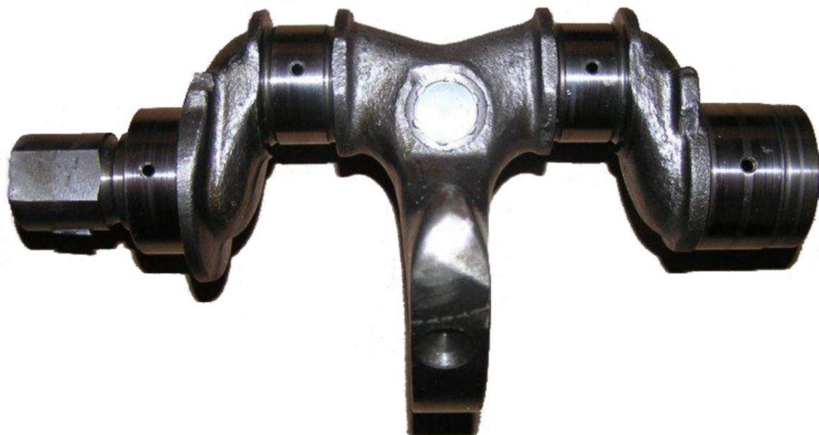
Obr. 2.3 Praktické provedení KH bez středního ložiska [6]
