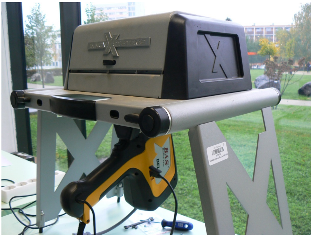
Obrázek P 19: Přenosný ruční XRF analyzátor Delta od firmy Urga s.r.o. umístěný v pracovním stojanu. Foto: D. Kabrhelová.
