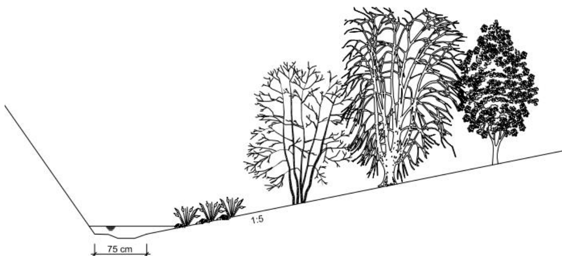
Obrázek 3.21: Návrh úpravy příčného profilu ve třetím úseku toku (zpracování: vlastní)
