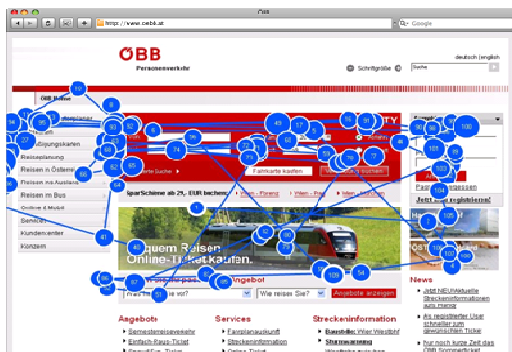
Obr. 5 GazePlot -Fixace reprezentované kružnicemi Sakády reprezentované liniemi spojujícími jednotlivé fixace (zdroj: http:// http://www.usecon.com/ )
