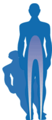
Obrázek 9. Vedení elektrického signálu tělem při BIA u bipolární osobní váhy Tanita (dle http://www.tanita.de/index.php?id=21 )
