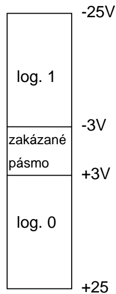
Obrázek 4: Napěťové úrovně u RS232 [8].
