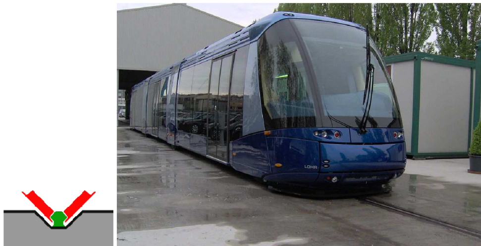
Obrázek 19: Systém Translohr vedený jedinou středovou kolejnici [12]
