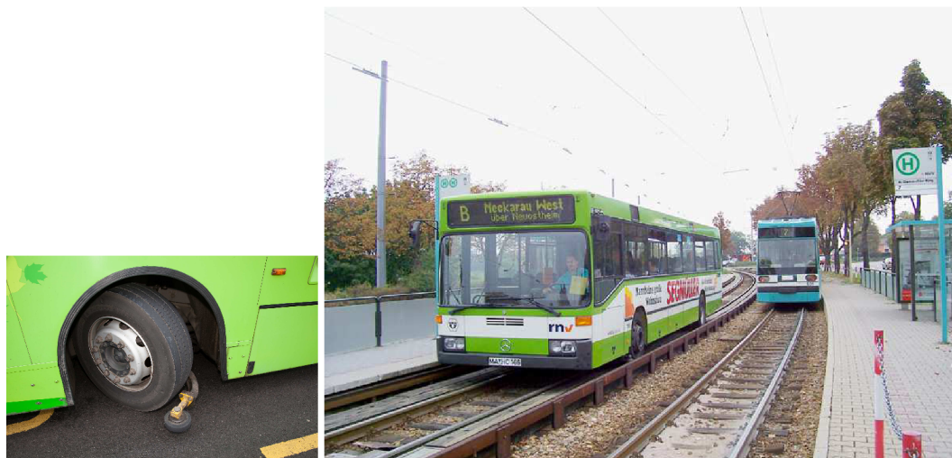
Obrázek 20: Systém Spurbus s bočně vedenými autobusy [13]
