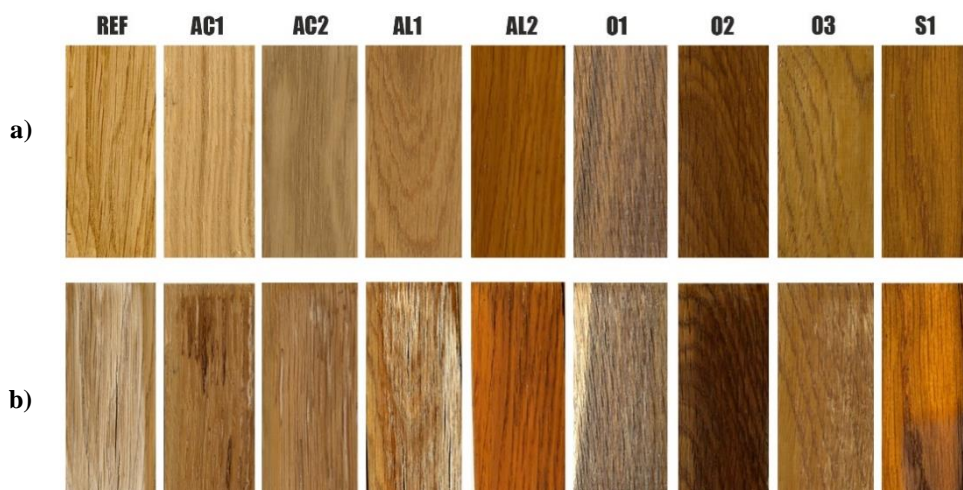
Obr. 27. Testované povrchy a) před vystavení zvětrání b) po 6 týdnech umělého stárnutí Pozn. Ref – Reference; AC – arylový nátěr; AL – alkydový nátěr; O – olejový nátěr; S – synestetický (uretanalkyd) nátěr
