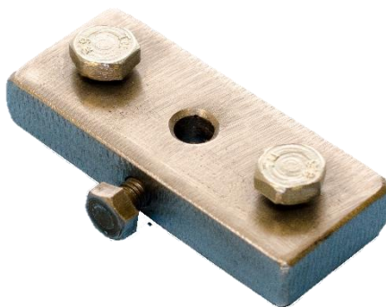
Obrázek 3.6: Přípravek pro uchycení termoanemometrického čidla
