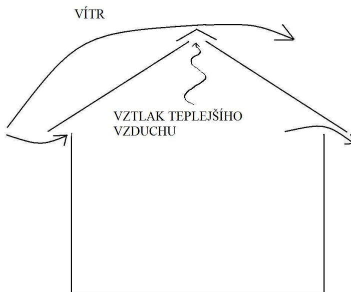
Obrázek 1. Systém přirozené stájové ventilace: otvory po stranách a ve hřebeni střechy (Wheeler, 2006).
