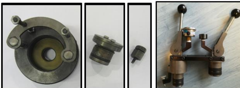
Obrázek 20 Staré přípravky (vlevo) a nový design přípravku (vpravo) [2]
