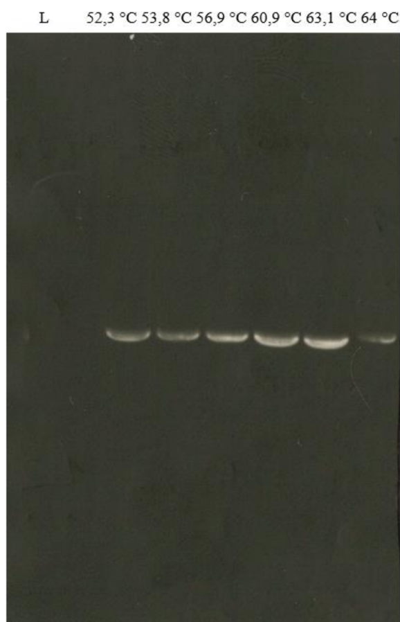
Obrázek 7: Výsledek teplotního gradientu. Na obrázku není vidět použitý Ladder z důvodu použití starého markeru.
