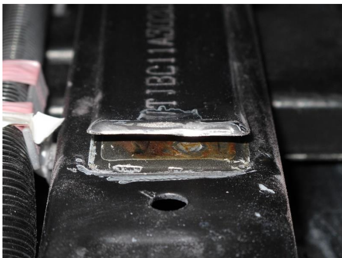
Obrázek 55 - Zjištěné překrytí VIN. Zdroj: OKTE Ústí nad Labem.
