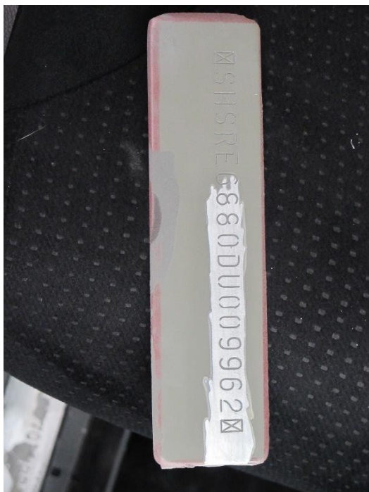
Obrázek 61 - Demontované překrytí se změněným VIN. Zdroj: OKTE Ústí nad Labem.
