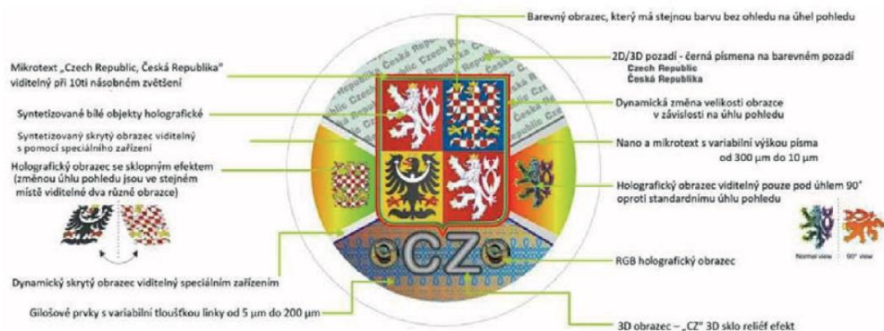
Obrázek 5- Holografická autodestruktivní samolepka. 14
