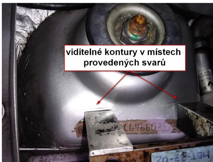
Obrázek 50 - Viditelné kontury svarů při použití magnetické práškové metody. Zdroj: OKTE Ústí nad Labem.
