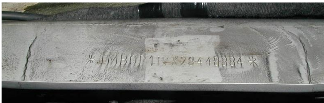
Obrázek 25 – Svár u VIN vozu Octavia. 53
