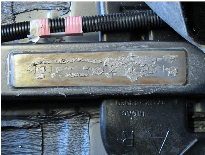
Obrázek 57 - Po odstranění překrytí, původní částečně viditelné VIN se zbytky pojící hmoty. Zdroj: OKTE Ústí nad Labem.
