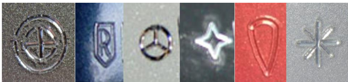
Obrázek 10 - Oddělovací znaky VIN výrobců: (zleva) BMW, Dacia, Mercedes, Opel, Peugeot, Škoda. 27
