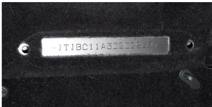
Obrázek 54 - Ražba VIN před zkoumáním. Zdroj: OKTE Ústí nad Labem.
