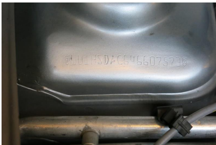
Obrázek 49 - Ražba VIN kódu před zkoumáním. Zdroj: OKTE Ústí nad Labem.
