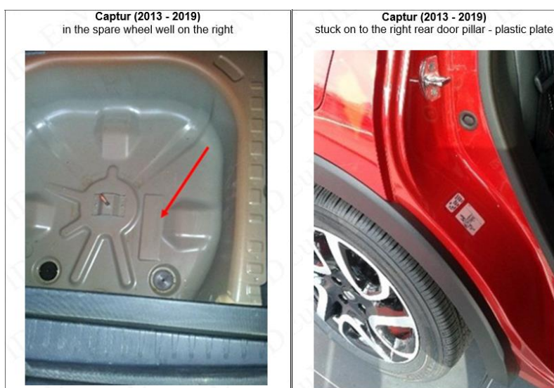
Obrázek 35 - Umístění hlavního VIN kódu a povinného štítku výrobce u vozidla Renault Captur. 79
