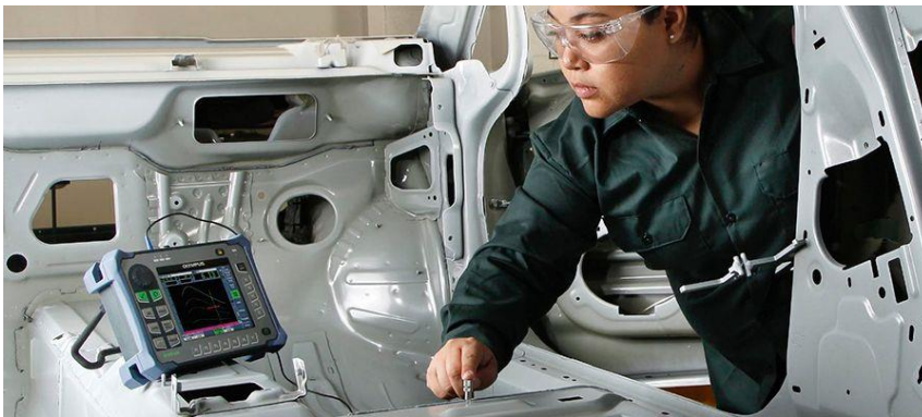
Obrázek 30 – Kontrola svarů ultrazvukovou metodou, přístojem Olympus EPOCH. 64
