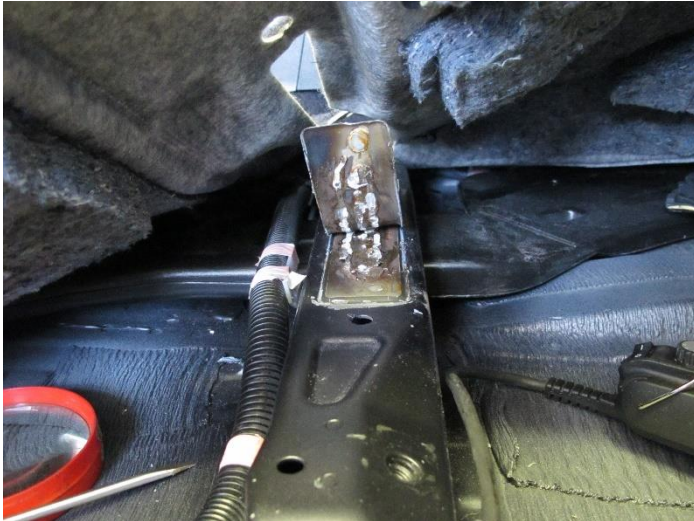
Obrázek 56 - Demontáž zjištěného překrytí VIN. Zdroj: OKTE Ústí nad Labem.
