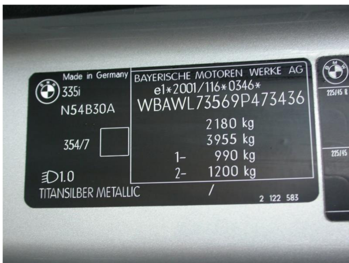
Obrázek 44 - Padělaný povinný štítek výrobce BMW. Zdroj: OKTE Ústí nad Labem.
