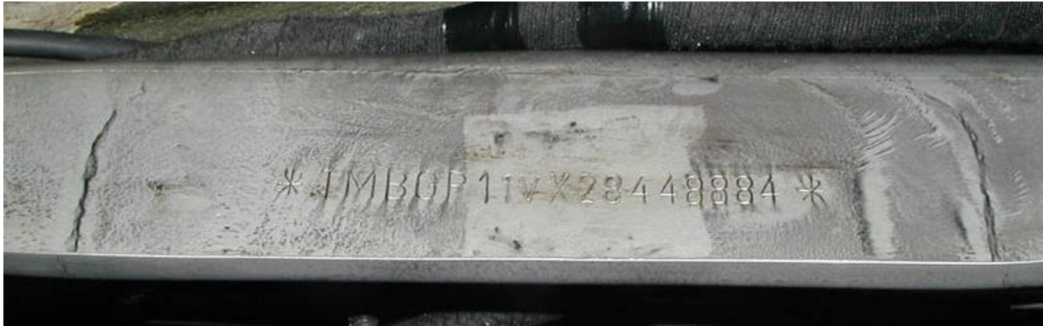
Obrázek 25 – Svár u VIN vozu Octavia. 53
