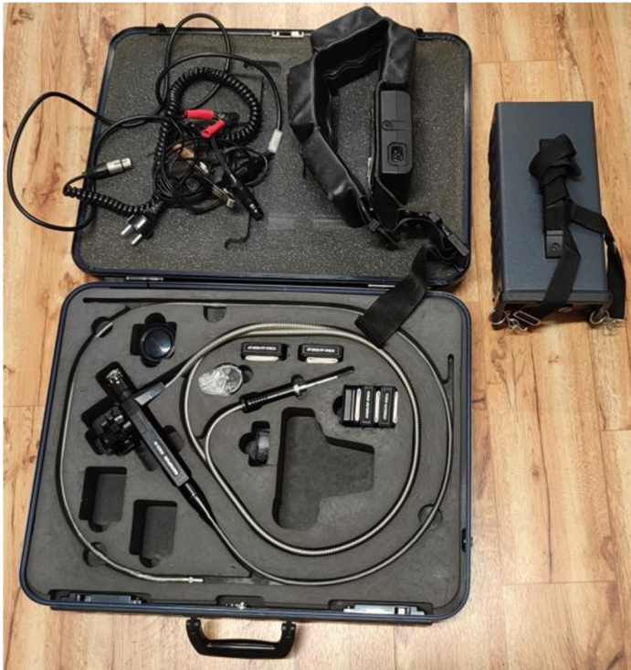
Obrázek 42 - Endoskop Olympus včetně světelného zdroje a bateriového pásu. Zdroj: Foto autor.
