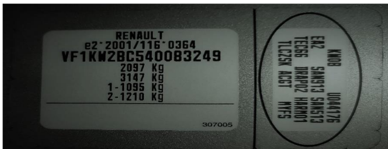
Obrázek 17 - Povinný štítek výrobce vozidla Renault Kangoo. Zdroj: Foto autor.
