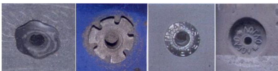
Obrázek 18 – Hlavy nýtů povinných štítků výrobce, zleva Chrysler, Honda, Subaru a Volvo. 38
