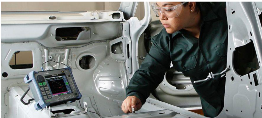
Obrázek 30 – Kontrola svarů ultrazvukovou metodou, přístojem Olympus EPOCH. 64
