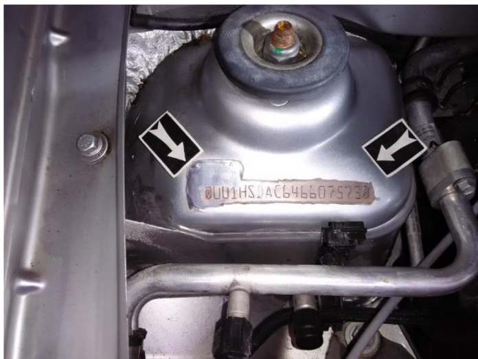
Obrázek 51 - Označení míst svarů pro odborné vyjádření. Zdroj: OKTE Ústí nad Labem.
