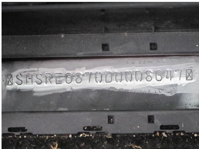
Obrázek 62 - Původní VIN vozidla po odstranění překrytí a pojící látky. Zdroj: OKTE Ústí nad Labem.
