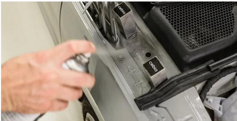
Obrázek 24- Magnetická prášková metoda při VIN testu společnosti Cebia 52
