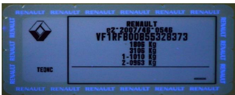
Obrázek 19 – Ukázka ochranného transparentního přelepu přes bílý homologační štítek. Po okrajích transparentní fólie je v UV světle patrný nápis RENAULT po celém obvodu nálepky. Zároveň můžeme spatřit trojúhelníkové „nářezy“, jež způsobují destrukci štítku v místě jejich výskytu při pokusu přenést štítek na jiné vozidlo. 40
