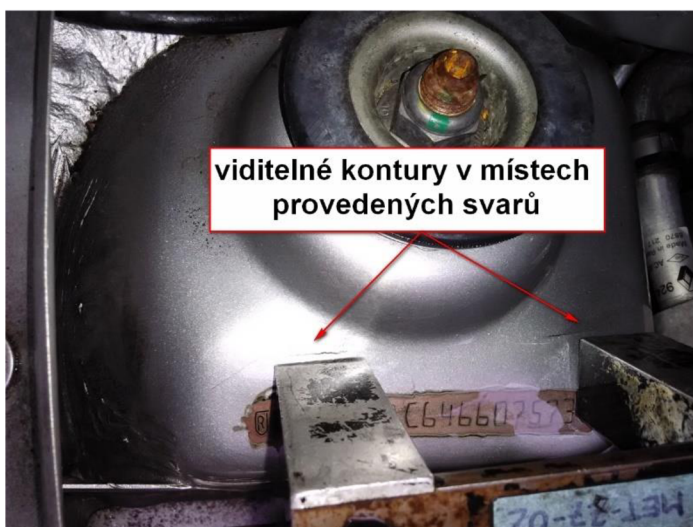
Obrázek 50 - Viditelné kontury svarů při použití magnetické práškové metody. Zdroj: OKTE Ústí nad Labem.
