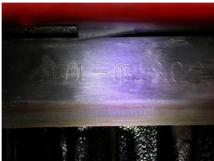
Obrázek 65 - Pohled na blok motoru po provedené tepelné metodě. Zdroj: OKTE Ústí nad Labem.
