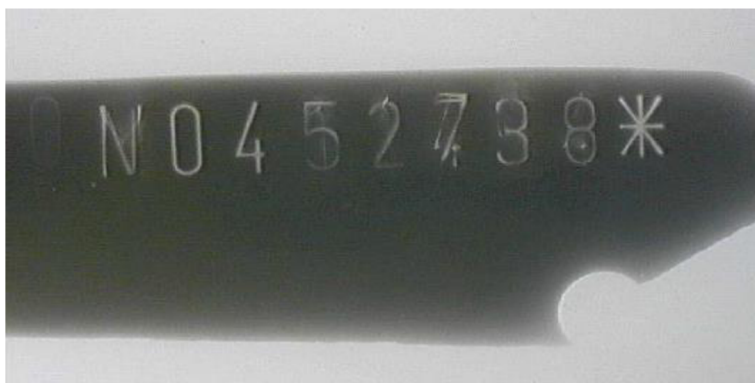
Obrázek 32 - RTG snímek vyříznutého identifikačního čísla vozidla (VIN) z vozidla Škoda Favorit. Na snímku je vidět, že pod písmenem N je jako předchozí označení písmeno M, pod číslicemi 5 a 2 číslice 1 a 1, pod číslicí 7 číslice 4, do označení pod číslicemi 3 a 8 byl zjištěn také zásah, ale nepodařilo se určit předchozí označení. 69
