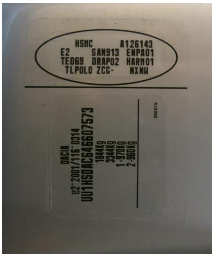
Obrázek 48 - Padělaný povinný štítek výrobce DACIA. Zdroj: OKTE Ústí nad Labem.
