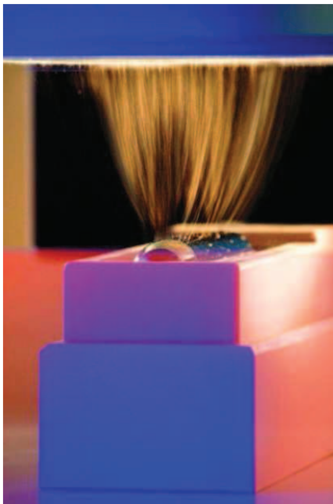
Obrázek 8 : Bezjehlový proces zvlákňování – rotační elektrospinning. http://www.elmarco.cz/fotogalerie/technologie-nanospider/
