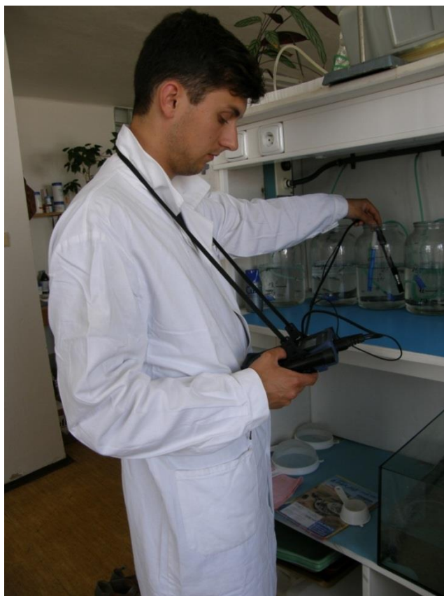
Obr. č. 2 Měření základních parametrů kvality vody v průběhu základních testů toxicity (foto J. Máchová)
