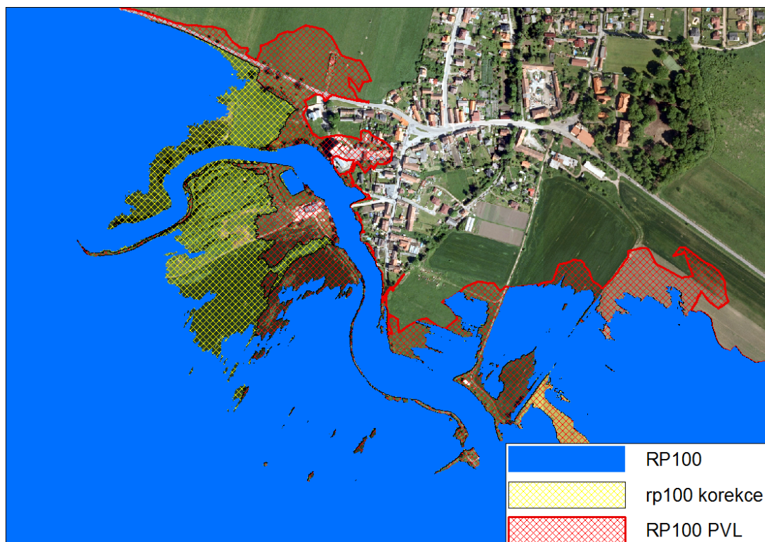
Obr. 47 – Porovnání oficiálního modelu s výsledkem HEC-RAS 5.0 a korekce nepřesností; zdroj: autor
