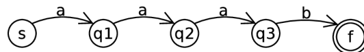
Obrázek 6.1: Jednoduchý konečný automat pro ukázkou závislosti počtu aktivních stavů na vstupním řetězci.
