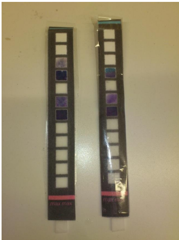
Obrázek 23: Test na tvrdost vody se sacím proužkem umístěným pod detekčními okénky.
