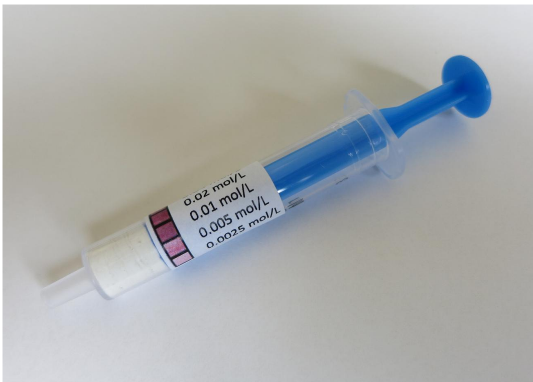
Obrázek 29: Fotografie lab-in-a-syringe testu s kalibrační řadou pro snadnou orientaci uživatele.
