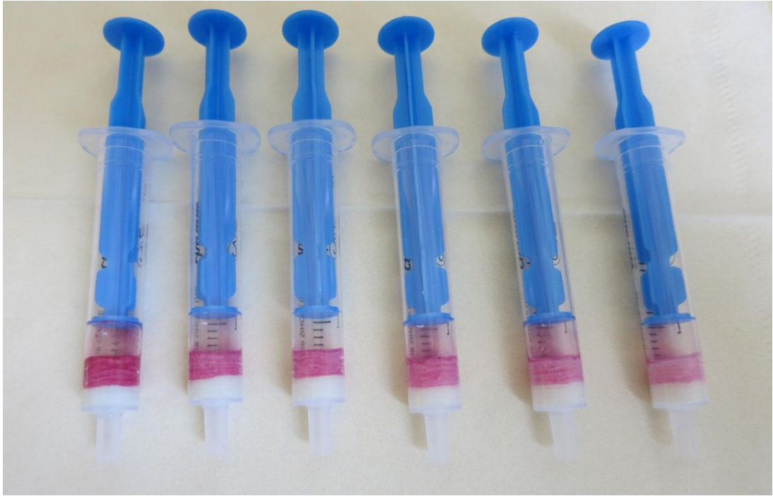
Obrázek 27: První druh testu s využitím detekční části z papírových kroužků.
