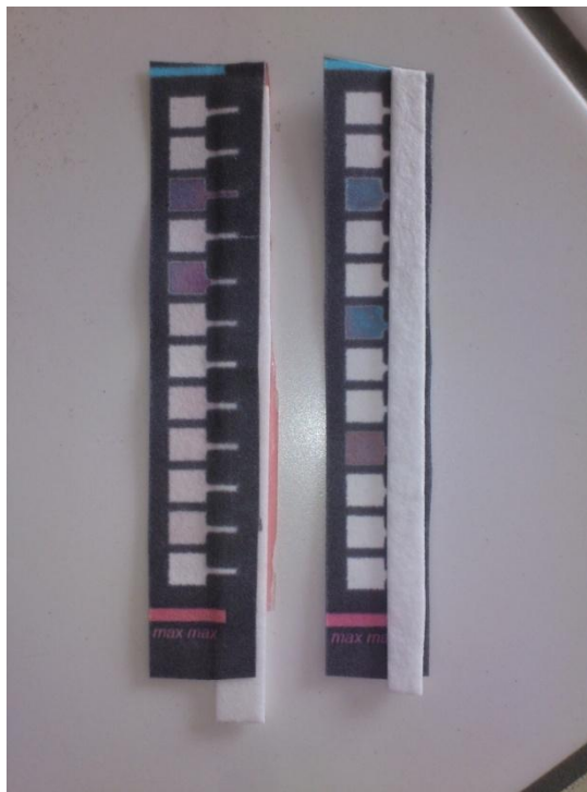
Obrázek 22: Test na tvrdost vody se sacím proužkem umístěným vedle detekčních políček.
