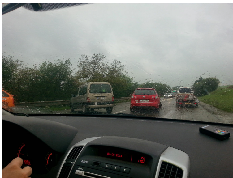
Obr. D.5: Fotografie při průjezdu kolem nehody při měření pomocí plovoucího vozidla s použitím přístroje MobiTex ® (na fotce vpravo na palubní desce).
