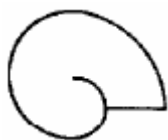
Obrázek 17: Značení pomalé pojistky[12]
