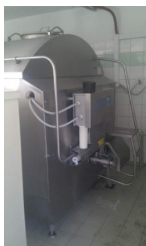
Obrázek 3.6 Tank na mléko – nádrž o kapacitě 3200 litrů s automatickým chlazením (SKŘIVÁNEK, 2016).
