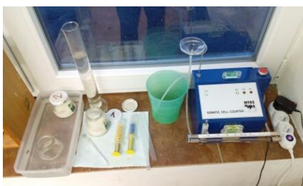
Obrázek 4.3 Stájová laboratoř pro rozbor mléka na ekologické farmě, přístroj MT05 s příslušenstvím (SKŘIVÁNEK, 2016).
