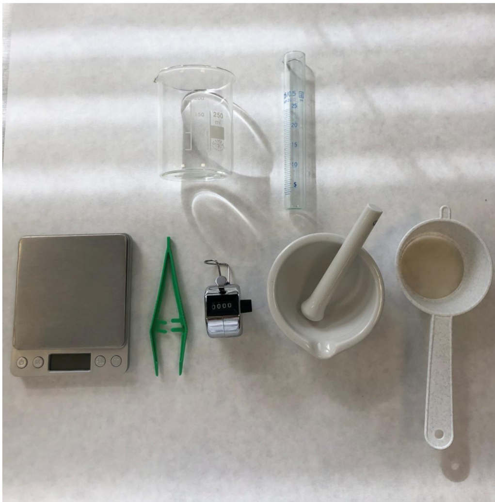
Obrázek 5 Váha, pinzeta, počítadlo, miska na drcení, sítko a kádinky (foto autor)
