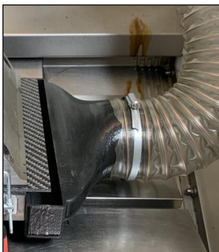
Obr. 17 – Odsávací nástavec 3D tištěný
