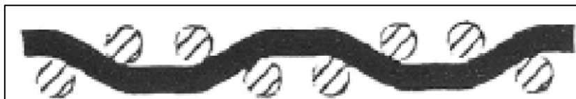
Obr. 6 – Řez textilií s keprovou vazbou [17]
