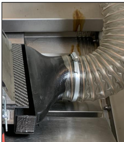
Obr. 17 – Odsávací nástavec 3D tištěný
