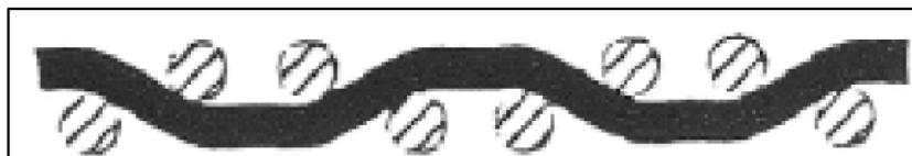
Obr. 6 – Řez textilií s keprovou vazbou [17]
