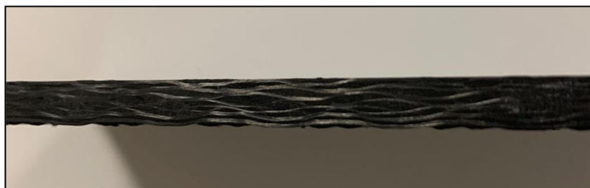
Obr. 12 – Řez kompozitní deskou
