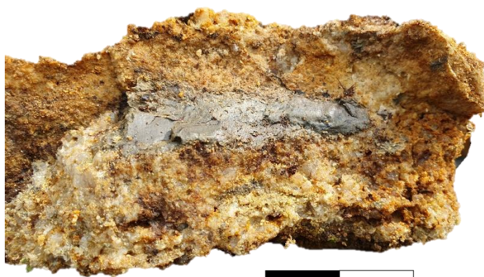
Obr. 18: Jemnozrný slepenec se závalky jílovců. Délka měřítka jsou 2 cm.
