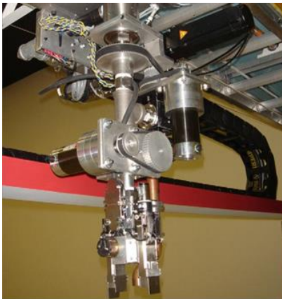
Obr 3- 3 Tisková hlava metody CC (vlevo), plnění stěny betonem (vpravo). [12][13]
