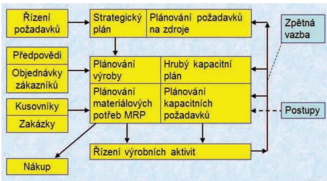
Obr. 5 Schéma principu činnosti systému MRP II [28].
