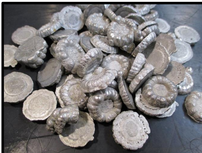
Obr. 5) Drobné kousky (pelety) niklu sloužící k naplnění anodického koše. [archiv HAO]
