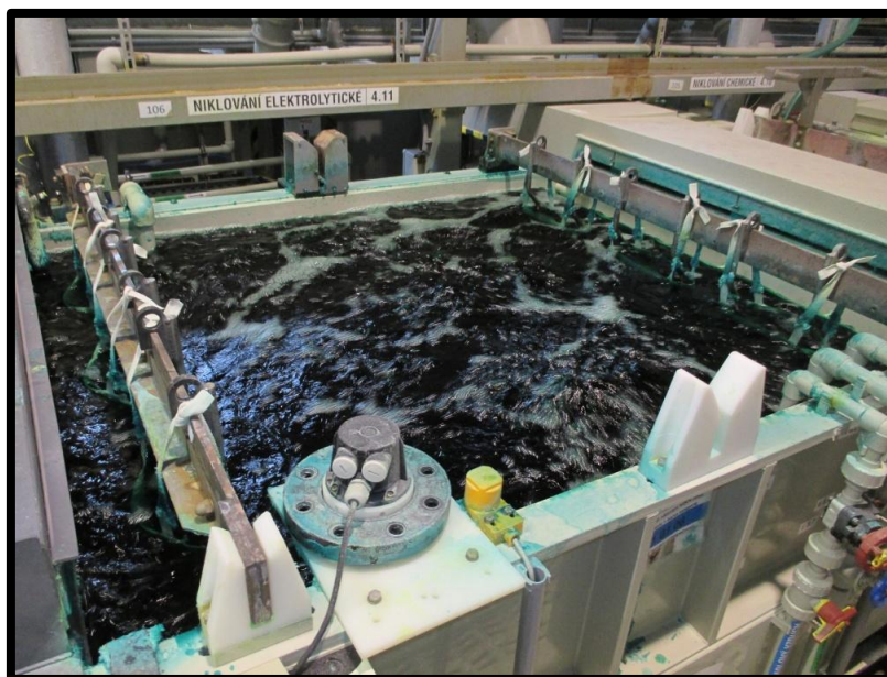
Obr. 9) Elektrolyt na bázi síranu nikelnatého jakožto nositel zeleně zbarvených Ni^{2+} iontů bývá pro galvanické niklování využíván nejčastěji. [archiv HAO]
