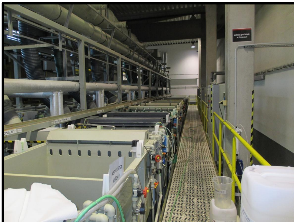
Obr. 7) Soustava jednotlivých van tvořících niklovací linku. [archiv HAO]
