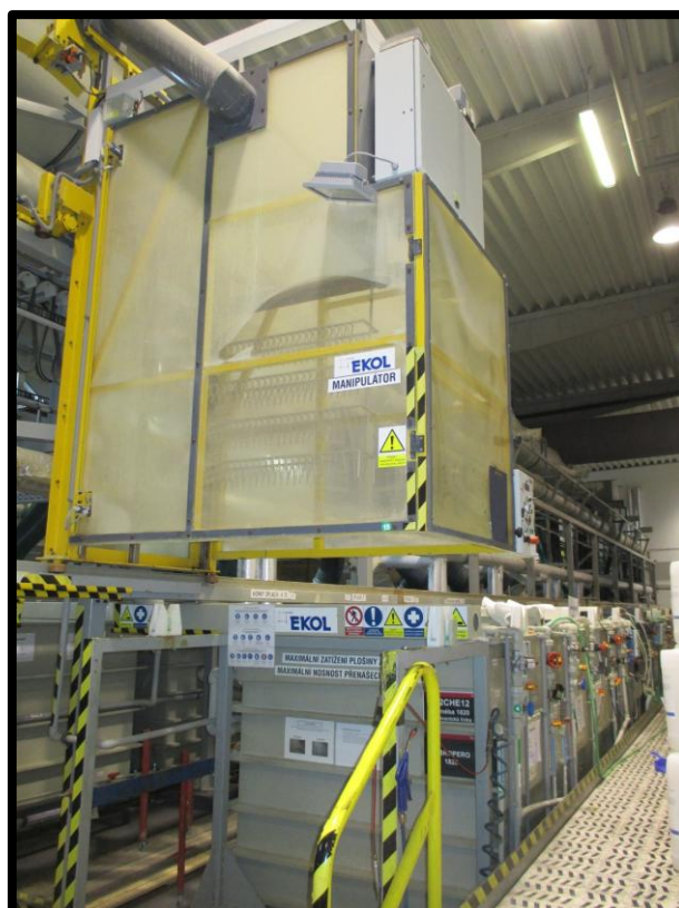
Obr. 8) Dopravník sloužící k přesunu komponenty do jednotlivých lázní. [archiv HAO]
